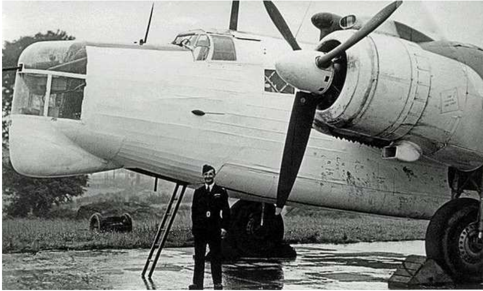
Wellington Mk XIV avec son radar ASV sous le nez de l'avion (airliners.net)
