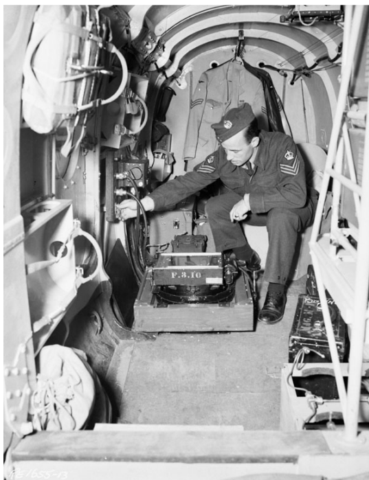
Installation de l'appareil photo à l'arrière d'un Avro-Anson (commons.wikimedia.org)
