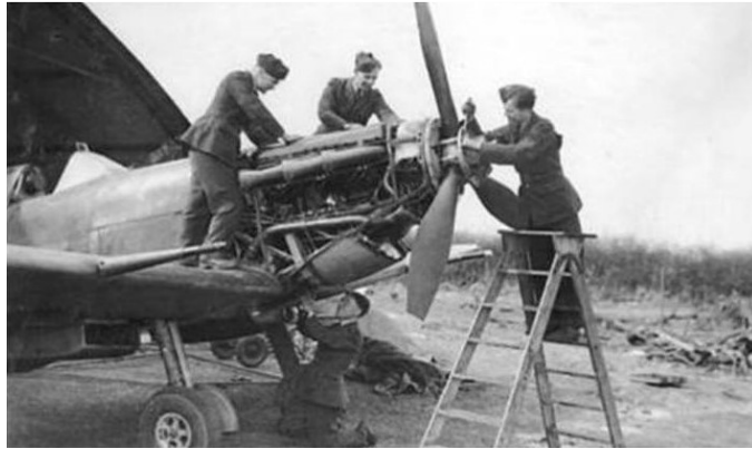
Maintenance sur un Spitfire VB à RAF King's Cliffe (20thfightergroup.com)
